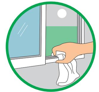
Mantenga limpios los canales de desagüe que hay en la parte interior de las ventanas de corredor y aluminio en sus marcos inferiores.
