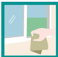
**Mantenga limpias las canaletas** de desagüe que hay en la parte interior de las ventanas correderas de aluminio en sus marcos inferiores.
